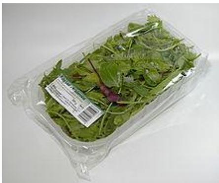
**Figure 3 : Blister à base d'acétate de cellulose, un bioplastique**
